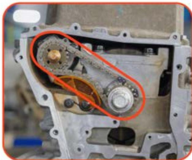
Exemple d'intervention corrective : remplacement de la chaîne de transmission.
